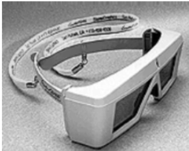
Bild 2: LCD-Shutter-Brille der Firma Crystal Eyes™
